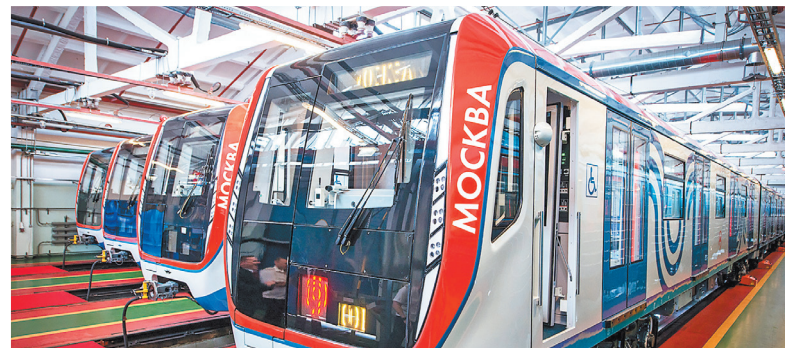
В новых поездах «Москва» используется система электродинамического торможения, которая обеспечивает плавное снижение скорости поезда вплоть до его полной остановки возле платформы станции. Фото: АГН «Москва»
